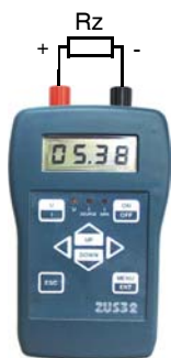
Obr.3 Zapojení ZUS32 v režimu generace napětí a proudu v aktivním režimu
